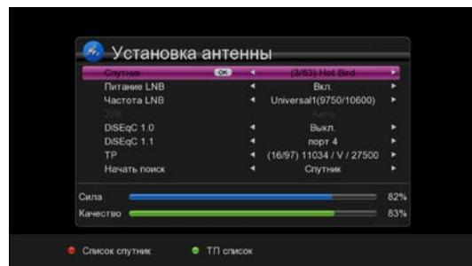
1 Нажимайте **[◀ / ▶]** для последовательного, один за другим, изменения параметров. Нажмите **[OK]** для проверки состояния каждой позиции. Для “LNB Power”, имеется две позиции на выбор: «Вкл/On» и «Выкл/Off». Если опция установлена на «On», то ресивер обеспечивает питание антенны. В противном случае, питание антенны отключено.
