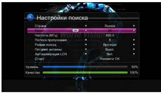
1 Поиск (Search): Здесь вы можете выбрать номер желаемого канала и задать параметры Частота/Диапазон/Режим (Frequency/Bandwidth/Mode).
